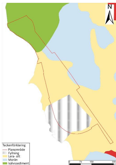
Figur 4. Jordartskarta från Sveriges Geologiska Undersökning (SGU) som visar att planområdet består av fyllnad, morän, lera-silt och isälvs sediment. Kartan är hämtad från SGU:s visningstjänst för jordarter 1:25 000 – 1:100 000.
