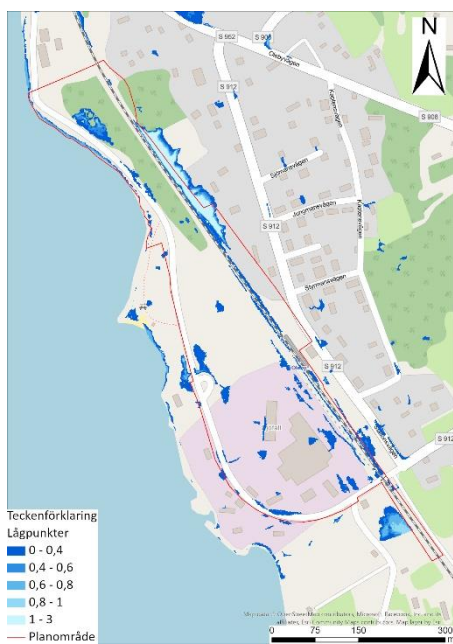
Figur 9. Vattendjup i lokala lågpunkter vid kraftig nederbörd (67 mm, motsvarande ett 100-års regn med 60 minuters varaktighet och klimatfaktor 25%). Bakgrund: Ortofoto från Lantmäteriets visningstjänst.
