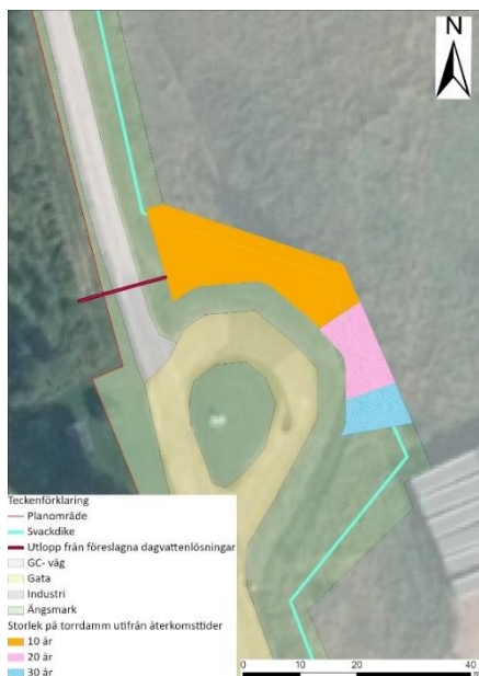
Figur 14. Förslag på systemlösning för utredningsområdet där stabiliteten har beaktats utifrån den geotekniska undersökningen.
