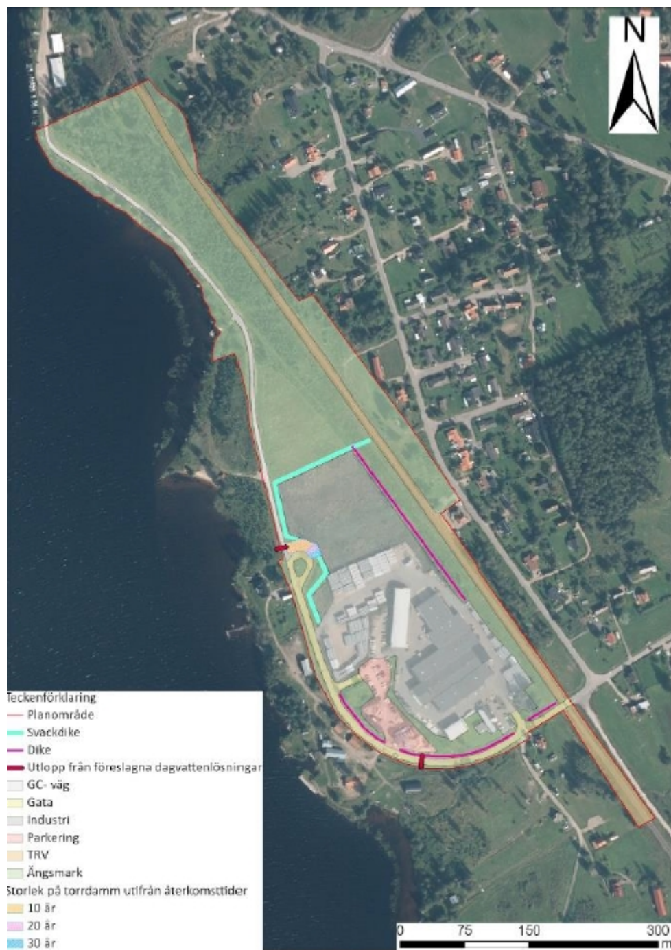
Bild 24: Illustration systemlösning för dagvattenhantering. Källa: SWECO, Dagvattenutredning.
